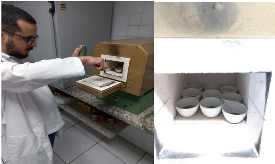
Figura 10 – Incineração de amostras de solo em forno tipo mufla para determinação dos teores de MOS.
