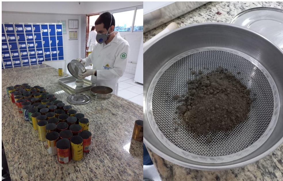
Figura 9 – Peneiramento das amostras de solo seca em estufa para a obtenção da TFSE.
