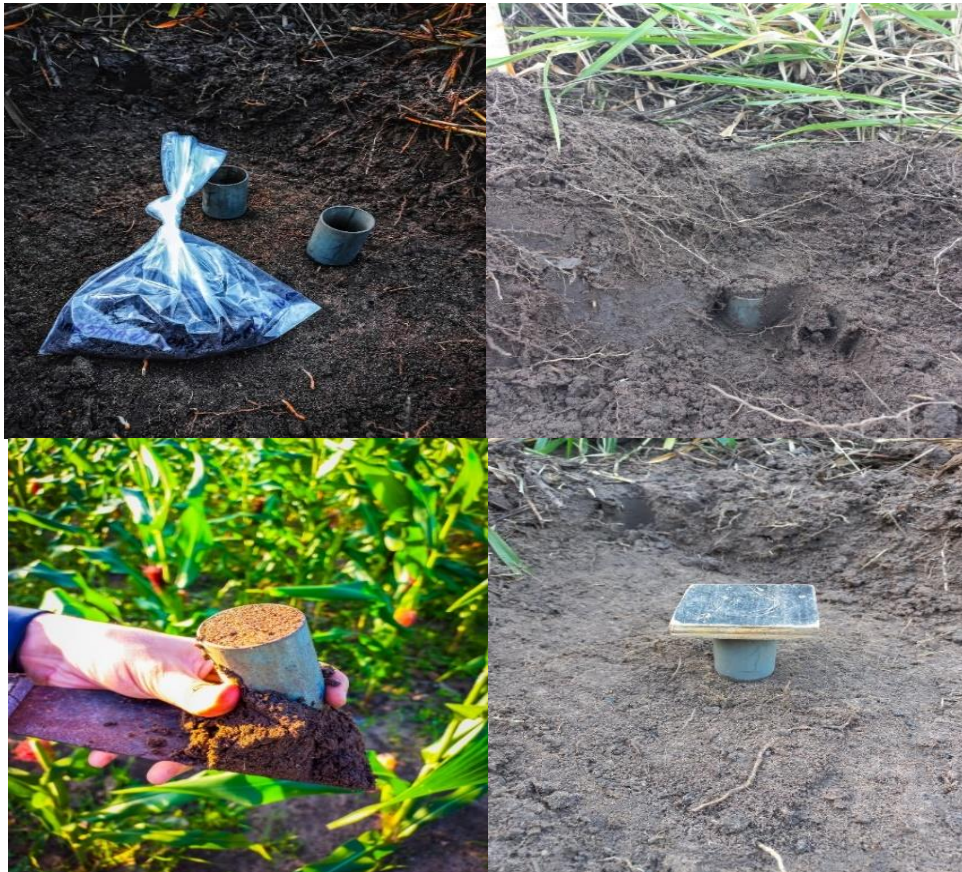
Figura 8 – Coleta de amostras indeformadas de solo.
