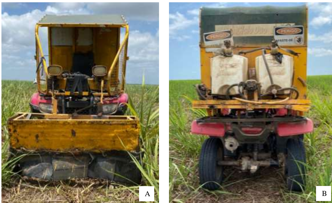
FIGURA 1. Pulverizador HerbiCiclo Duo®. A) Vista frontal do quadriciclo; B) Vista traseira do quadriciclo. Fonte: Arquivo Pessoal (2021).
