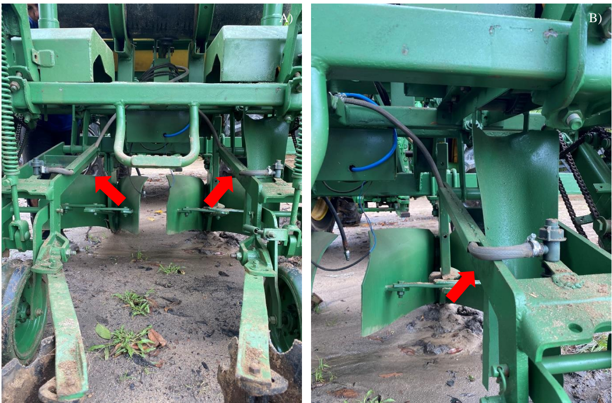
Figura 21 – Circuito de pulverização do protótipo para plantio da cana-de-açúcar. A) Suporte de fixação das mangueiras; B) Mangueira e anti-gotejo com pontas (bicos).
