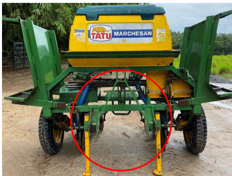
Figura 3 – Pontos de acoplamento originais da plantadora de mandioca. Fonte: Elaborada pelo autor (2022).
