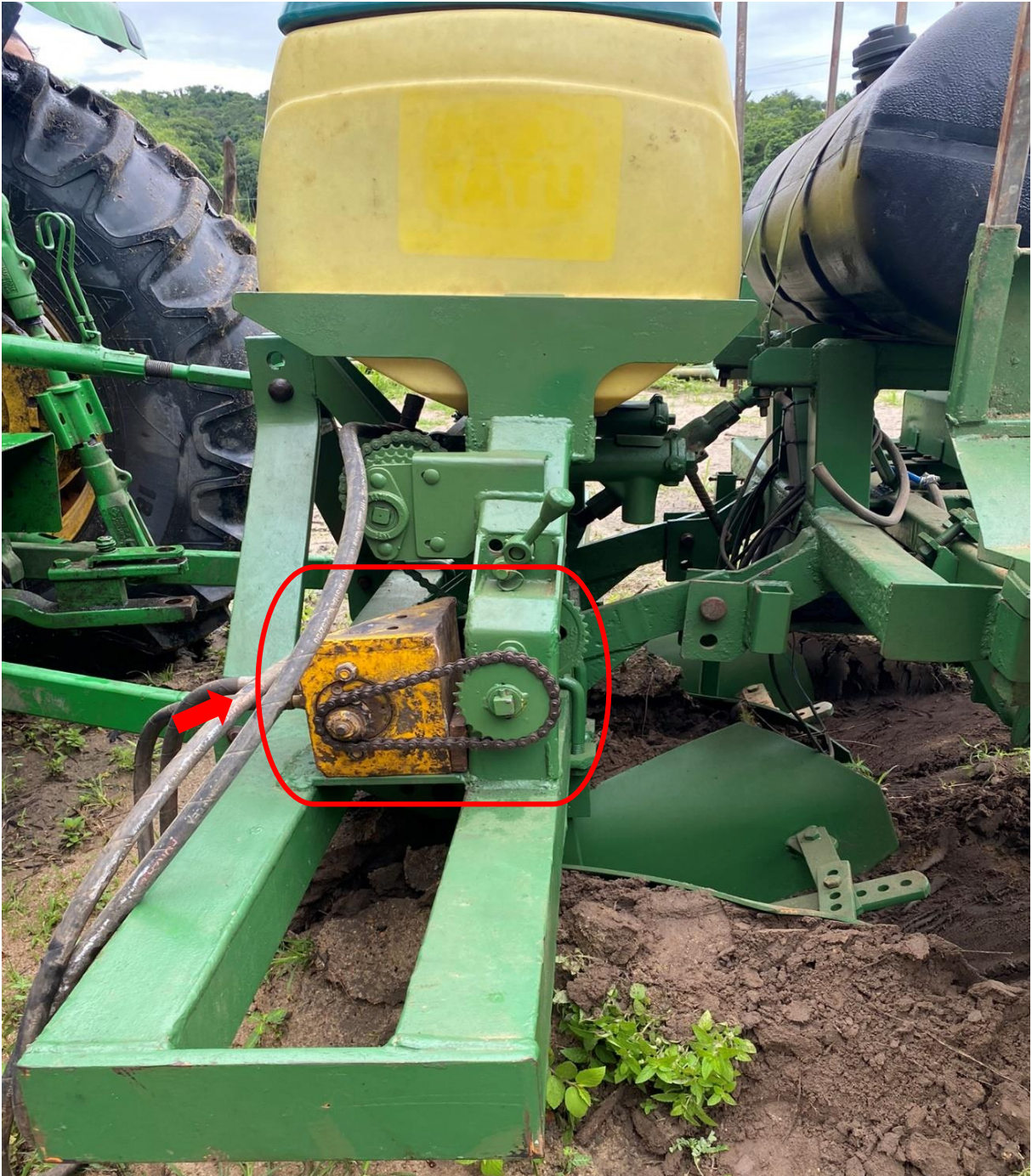
Figura 24 – Motor hidráulico instalado no sulcador para distribuição de adubo. Fonte: Elaborada pelo autor (2022).
