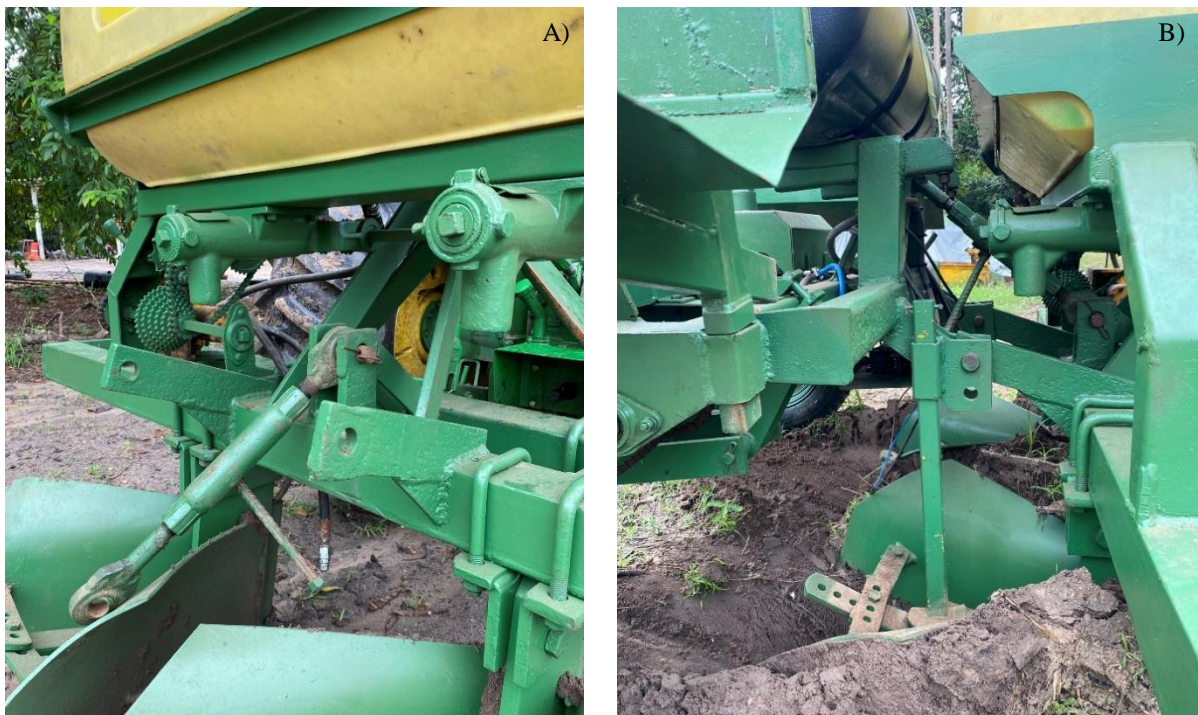
Figura 26 – Suporte para acoplamento da plantadora ao sulcador. A) Pontos de acoplamento no sulcador; B) Plantadora acoplada ao sulcador.
