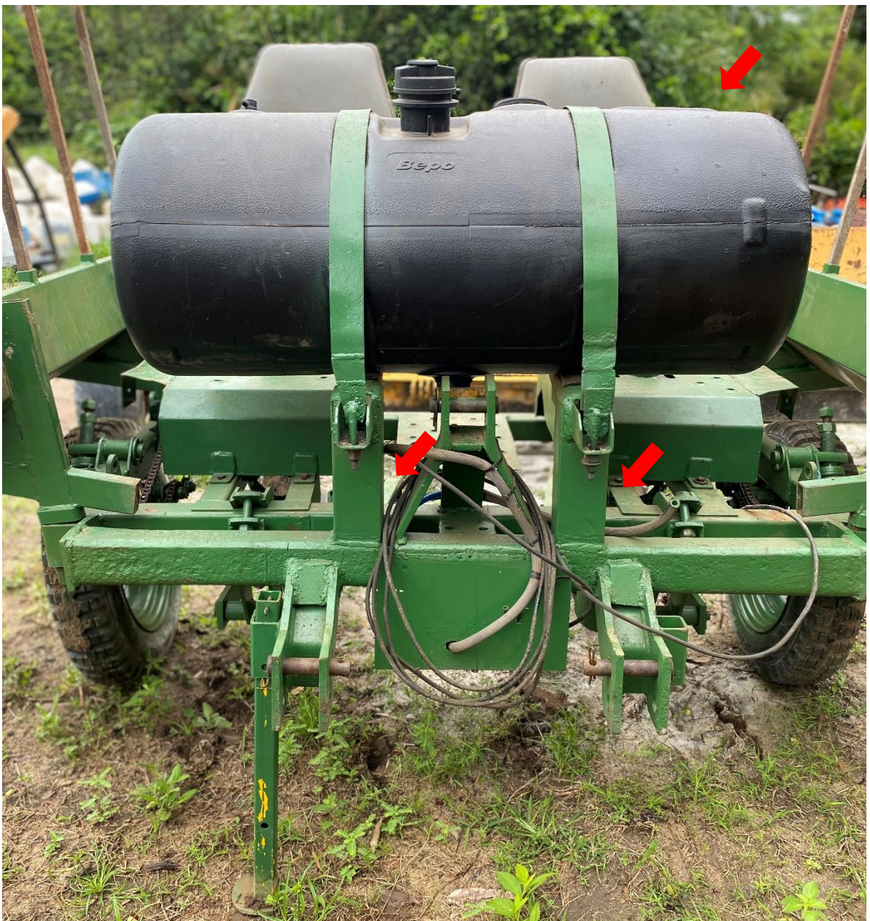
Figura 8 – Reservatório para produtos agrícolas do protótipo.
