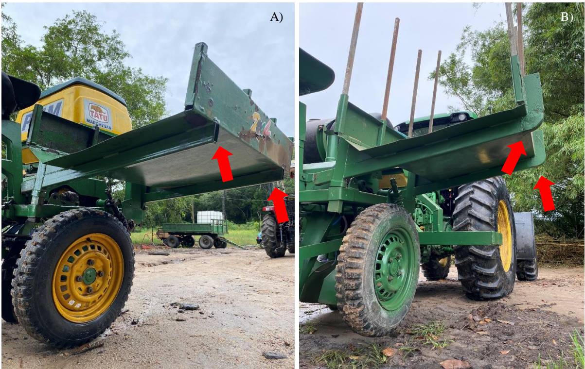
Figura 5 – Plataforma de ramas antes e após modificação. A) Vista lateral direita da plataforma de ramas original da plantadora de mandioca; B) Vista lateral direita da plataforma de ramas do protótipo após modificação.
