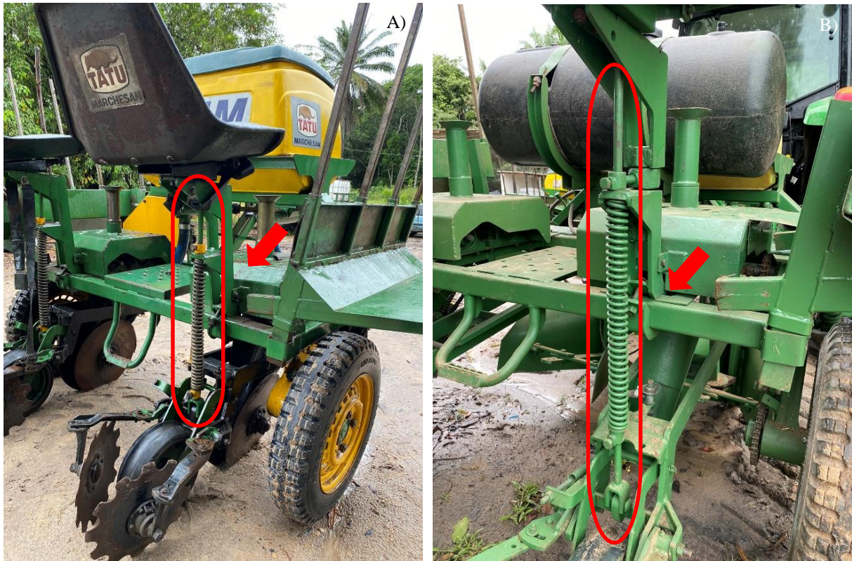
Figura 15 – Varão de ajuste de profundidade das linhas de plantio. A) Varão de ajuste de profundidade original; B) Varão de ajuste de profundidade após modificação.
