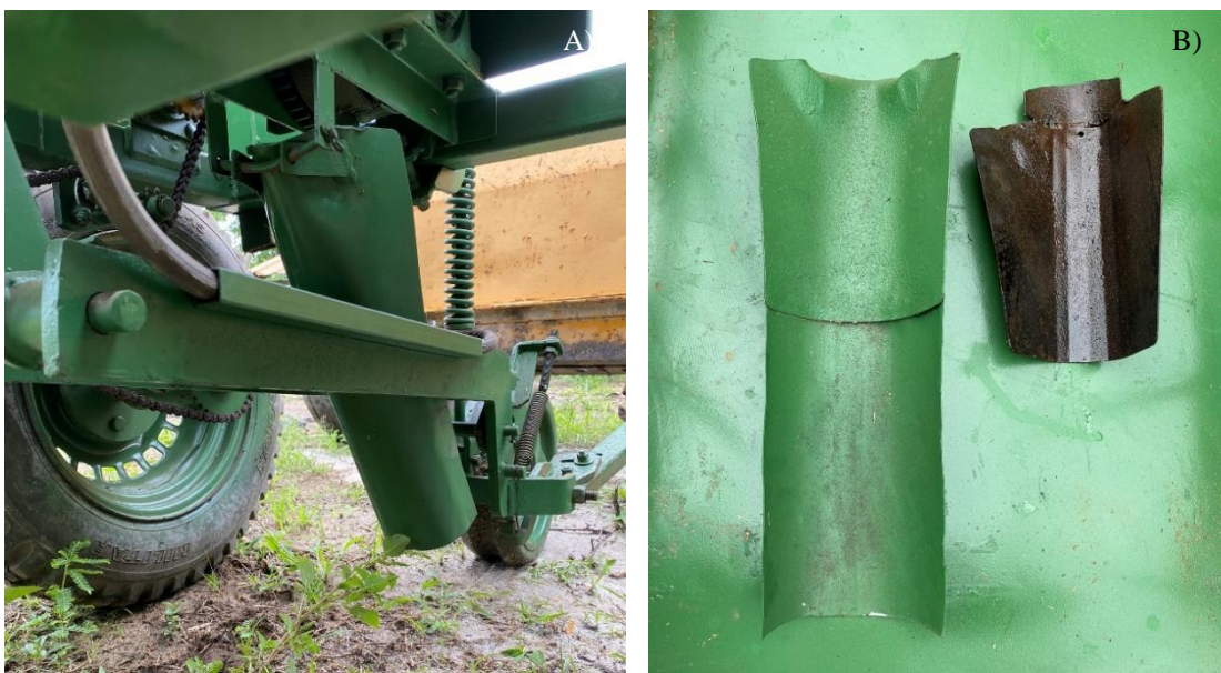
Figura 14 – Calha de descida dos toletes de cana-de-açúcar. A) Calha de descida dos toletes de cana-de-açúcar após prolongamento; B) Comparativo da calha de descida antes e após modificação.
