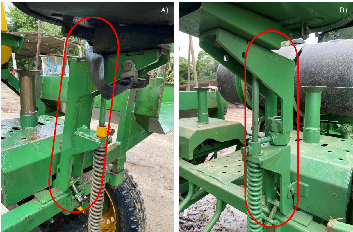
Figura 19 – Suporte da cadeira dos operadores de plantio. A) Suporte da cadeiras dos operadores de plantio da plantadora de mandioca; B) Suporte da cadeiras dos operadores de plantio do protótipo da plantadora de cana-de-açúcar.
