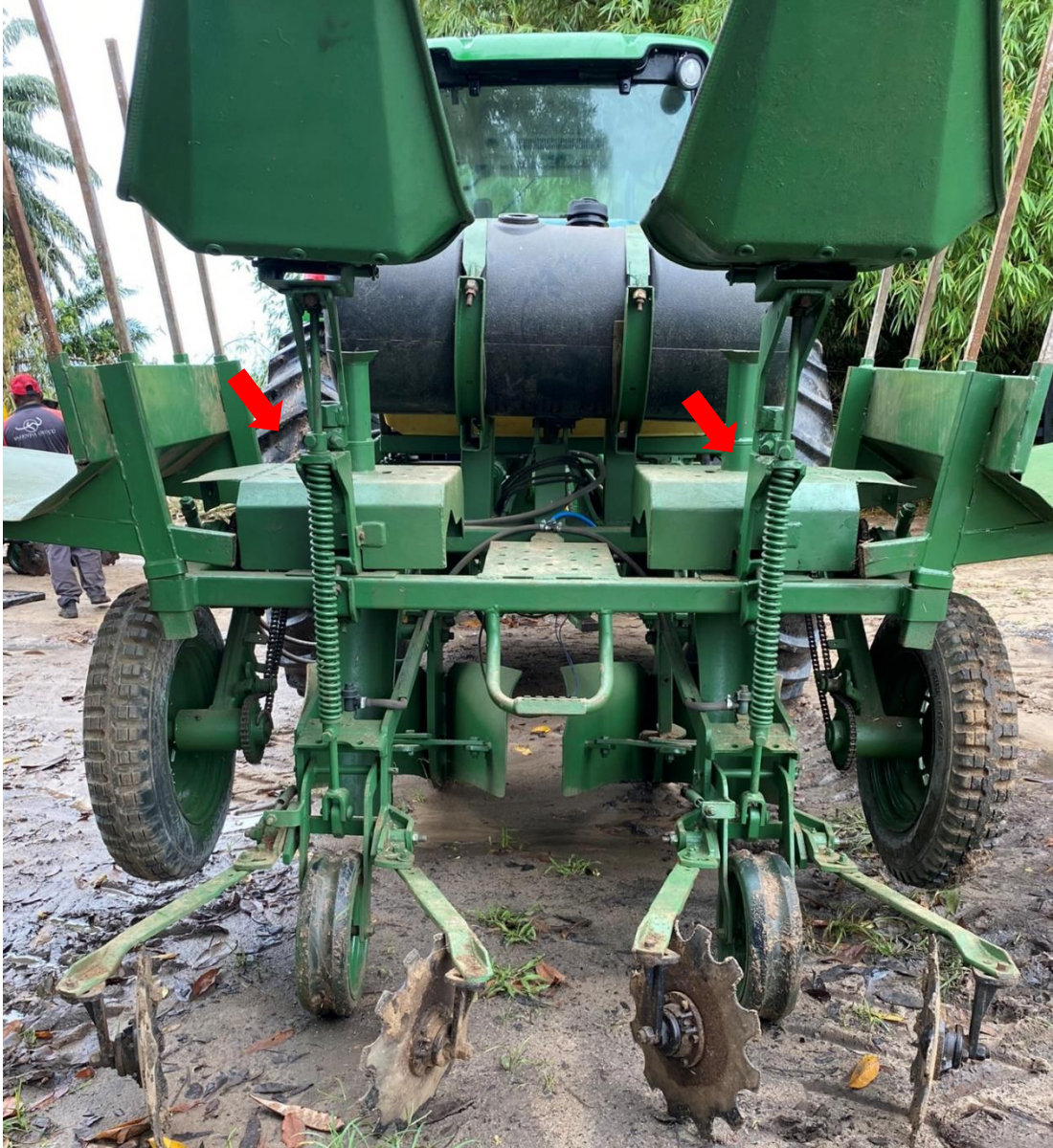
Figura 20 – Suportes das cadeiras dos operadores e linhas de plantio do protótipo. Fonte: Elaborada pelo autor (2022).
