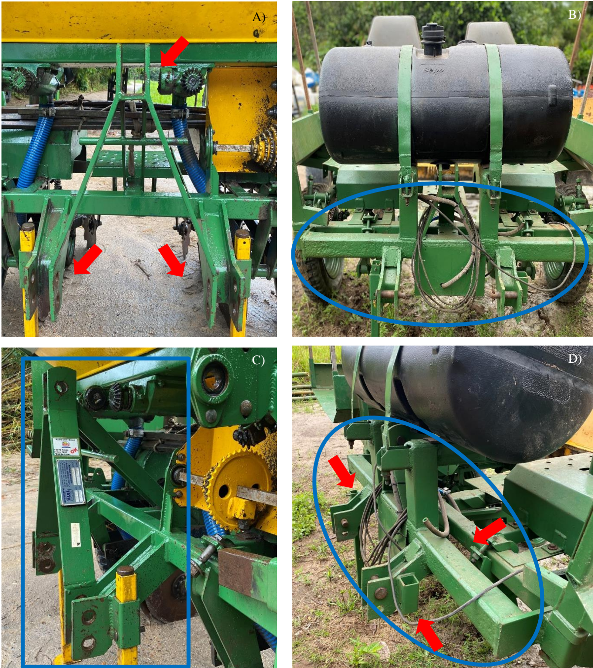
Figura 4 – Pontos de acoplamento antes e após modificação. A) Vista frontal dos pontos de acoplamento originais da plantadora de mandioca; B) Vista frontal dos pontos de acoplamento do protótipo após modificação; C) Vista lateral esquerda dos pontos de acoplamento originais da plantadora de mandioca; D) Vista lateral esquerda dos pontos de acoplamento do protótipo após modificação.
