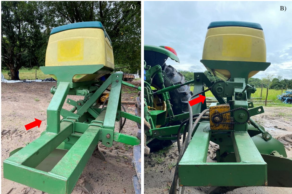
Figura 23 – Depósito de adubo no Sulcador. A) Vista lateral direita do sulcador; B) Vista lateral esquerda do sulcador.
