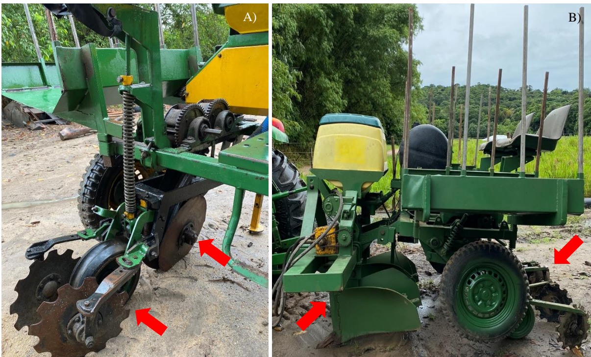
Figura 17 – Sistema de abertura e fechamento dos sulcos da plantadora de mandioca e protótipo para plantio da cana-de-açúcar. A) Sistema de abertura e fechamento dos sulcos da plantadora de mandioca; B) Sistema de abertura e fechamento dos sulcos do protótipo para plantio da cana-de-açúcar.
