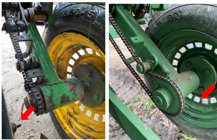
Figura 13 – Engrenagem motora. A) Engrenagem motora original da plantadora de mandioca; B) Engrenagem motora do prototipo para plantio da cana-de-açúcar.
