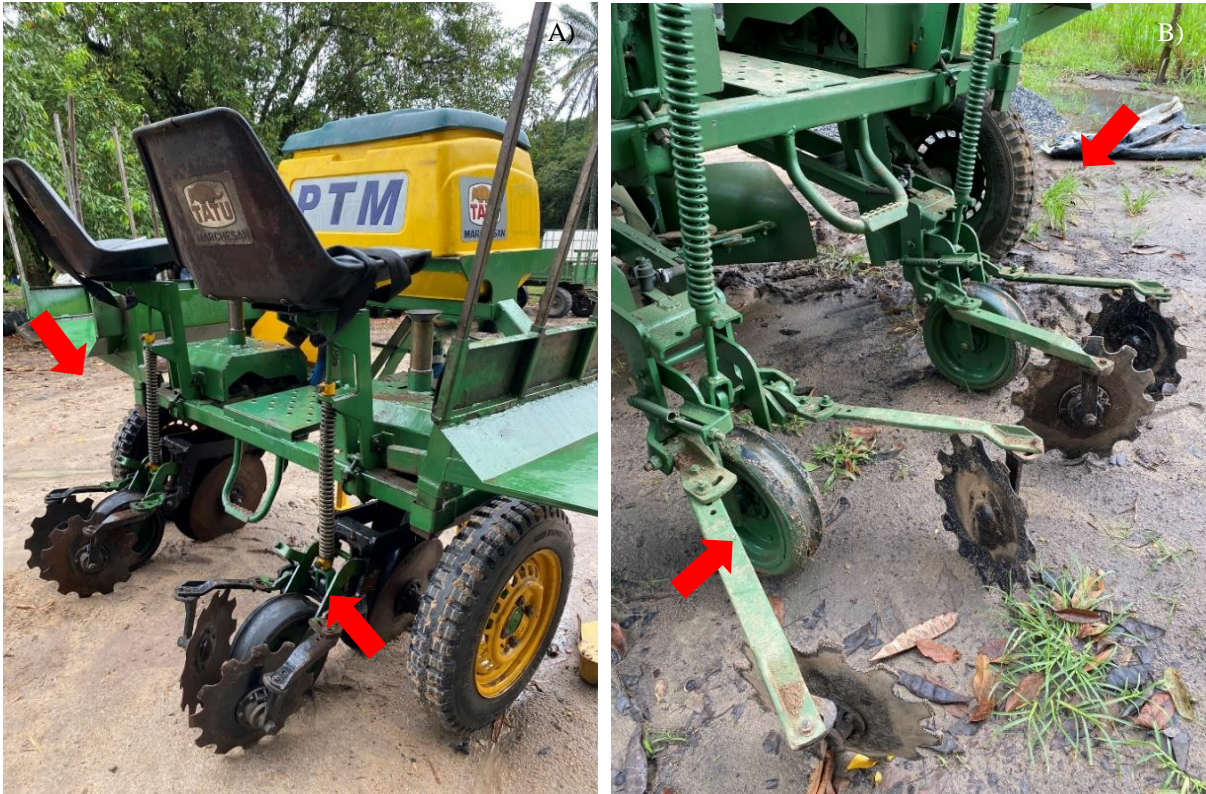
Figura 18 – Suportes de sustentação dos discos cobridores. A) Suportes de sustentação dos discos cobridores da plantadora de mandioca; B) Suportes de sustentação dos discos cobridores do protótipo para plantio da cana-de-açúcar.
