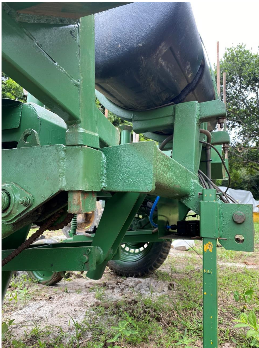
Figura 11 – Fixação de bomba elétrica na parte frontal inferior do chassi, para a aplicação e dos produtos agrícolas.
