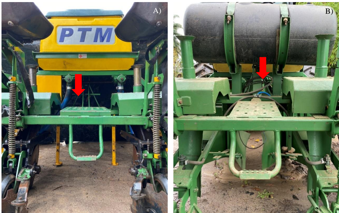
Figura 6 – Piso/assoalho central de apoio antes e após modificação. A) Vista frontal do piso/assoalho central de apoio original da plantadora de mandioca; B) Vista frontal do piso/assoalho central de apoio do protótipo após modificação.
