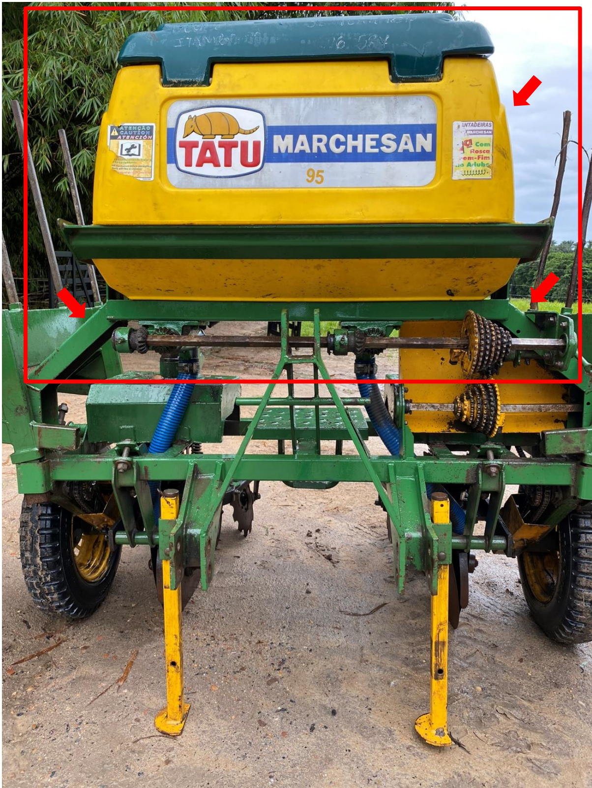
Figura 7 – Depósito de abudo da plantadora de mandioca e sistema de transmissão (engrenagens).
