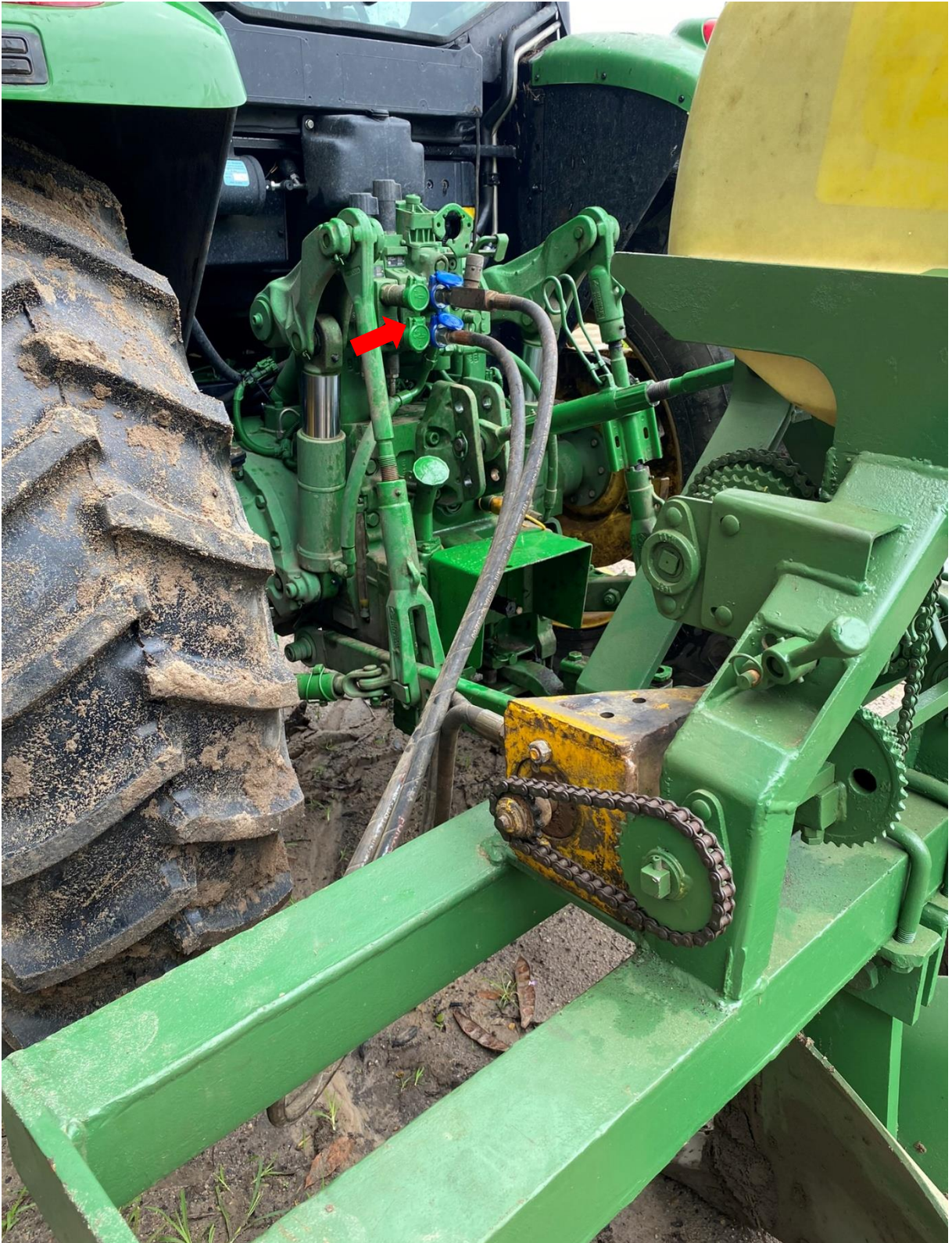
Figura 25 – Mangueiras hidráulicas de alta pressão ligadas ao sistema hidráulico do trator.
