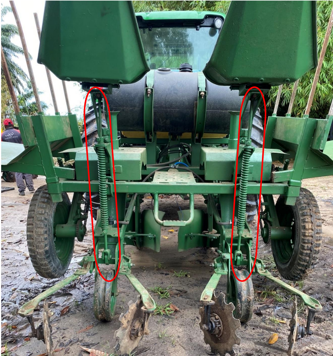
Figura 16 – Varões de ajuste de profundidade após modificação.
