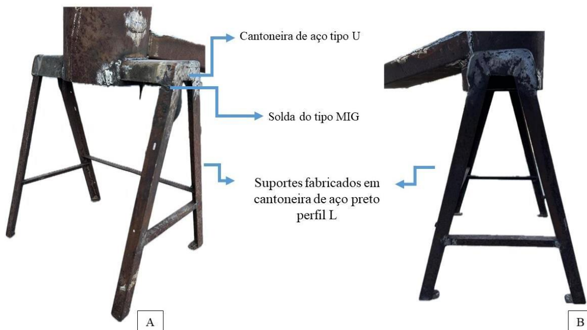
Figura 4 – Estrutura do protótipo de triturador de matéria orgânica. A) cantoneira de aço tipo U após corte e união a cantoneira de aço preto perfil L, por meio de meio de solda MIG (metal inerte gás), B) vista lateral da estrutura tipo cavelete. Fonte. autoria própria.
