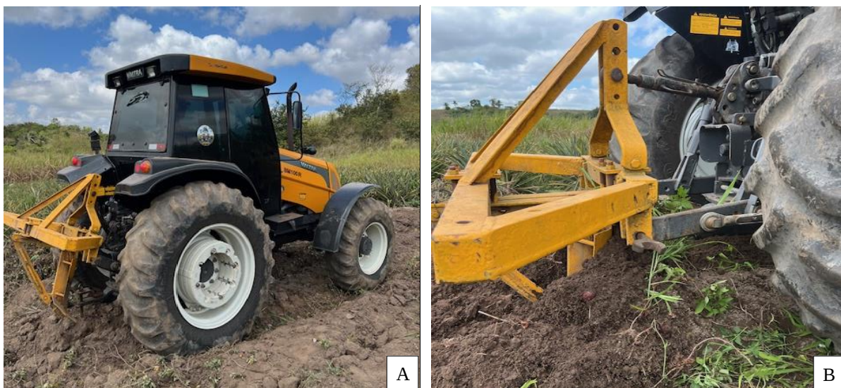
FIGURA 4 – Trator Valtra, modelo BM100, utilizado no estudo. A) arrancador acoplado ao trator agrícola, B) arrancador sendo tracionado por trator agrícola, realizando o arranquio da batata-doce. Fonte: Autoria própria.
