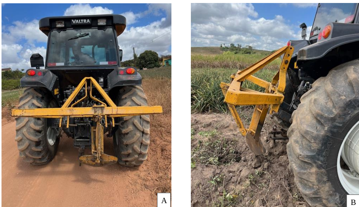
FIGURA 4 – Arrancador utilizado na colheita semi-mecanizada da batata-doce. A) vista taseira do arrancador acoplado ao trator agrícola; B) vista lateral direita do arrancador acoplado ao trator agrícola. Fonte: Autoria própria.
