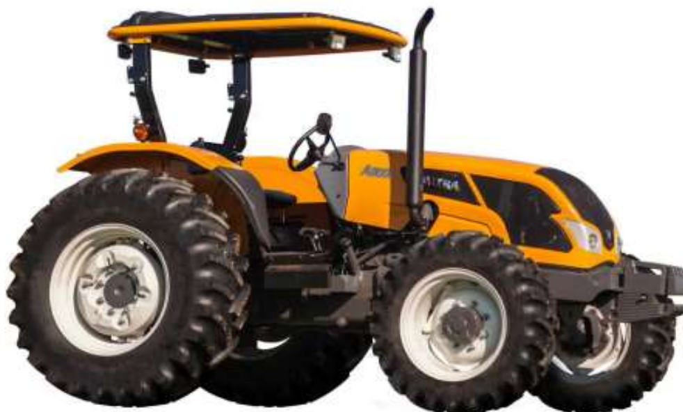
FIGURA 6. Trator Valtra, modelo A800R, 4 X 2 TDA, utilizado no estudo. Fonte: Valtra Brasil (2019).
