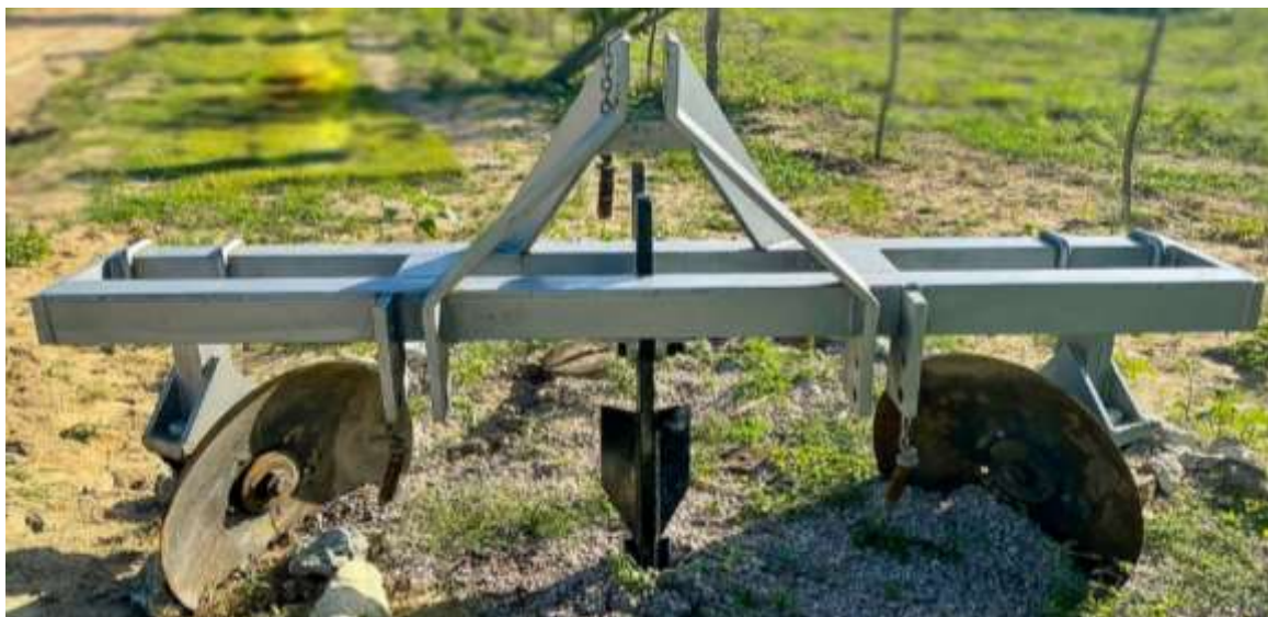
FIGURA 1. Sulcador montado de 2 discos. Fonte: Autoria Própria (2022).
