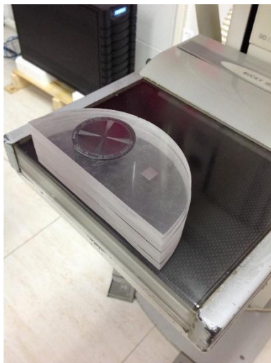
Figura 4- Arranjo experimental para avaliação da resolução espacial.
