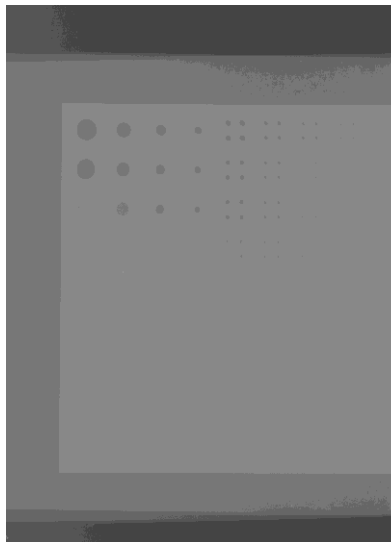
Figura 7- Imagem obtida para levantamento da curva contraste-detalhe.
